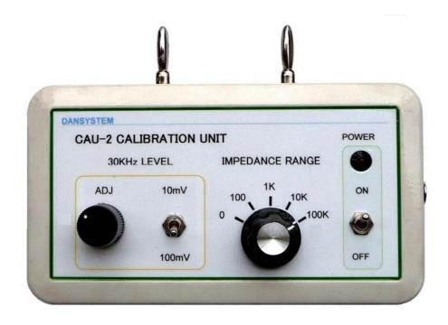
水晶発振器を内蔵した小型30KHz発振器で、CLT-1/CLT-10/CLT-20部品直線性試験装置を校正するために使用します。マルチメーター(周波数も30KHzが測定できるもの)と組み合わせて使用します。
