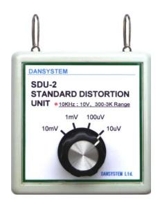
CLT-1/CLT-10/CLT-20 部品直線性験装置が正常に動作している事を確認する為に使用します。10KHz電圧を10V印加し、ダイアルを10mV/1mV/100uV/10uVに合わせた時30KHz電圧が各電圧になるかどうかをチェックします。 すべてのインピーダンスレンジにてチェックできます。
