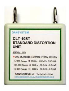
CLT-1/CLT-10/CLT-20 部品直線性験装置が正常に 動作している事を確認する為に使用します。10KHz電圧を10V 印加した時30KHz電圧が10mV±5%以内(基本レンジ)になる かどうかを チェックします。
